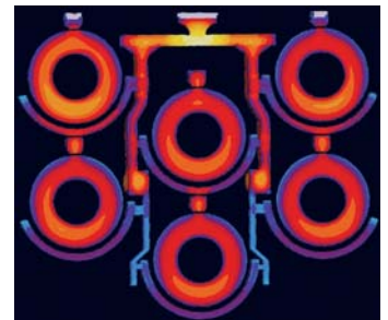
Simulation des Gussvorgangs bei der Herstellung von Bremscheiben (MAGMA)
