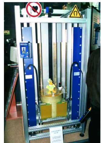
Der supraleitend gelagerte Cleanlift wurde 2001 als Weltneuheit auf der Hannover Messe vorgestellt
