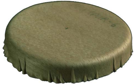
Abb. 3: umgeformtes Furnierlaminat, (0,6 mm dick), Form: Durchmesser 80 mm, Kantenradius 10 mm
