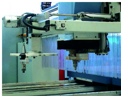
Abb. 2: CNC-Oberfräsmaschine SC20T der Firma MAKa mit Glättadapter
