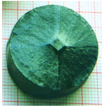
Der Hochtemperatur-Supraleiter YBaCuO als technischer Einkristall
