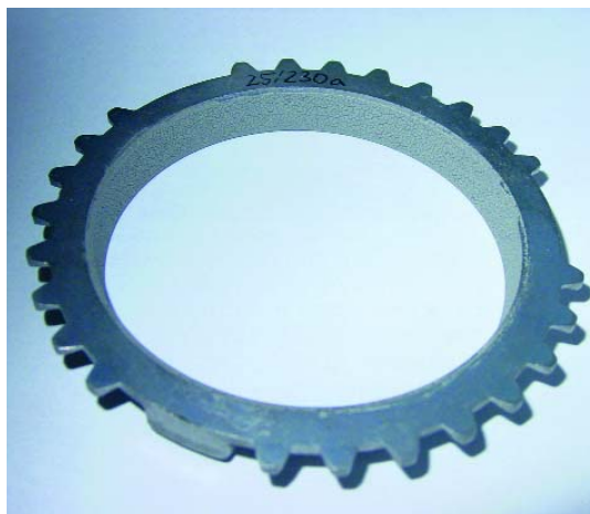
Bild 2: Synchronring mit neuartiger Reibschicht für PKW-Schaltgetriebe
