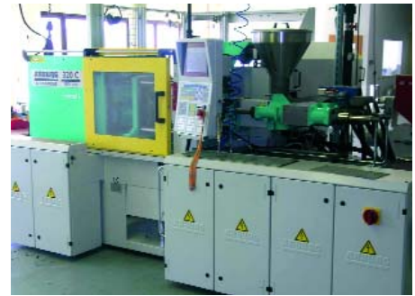
Spritzgießmaschine, Arburg Allrounder 320C Formgebung der Bauteile
