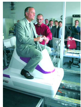
SupraTrans – Die Magnetbahn mit Supraleitern im Trag- und Führungssystem
