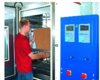
Abb. 2: Prüfung von Bauteilen im Doppelkammerklimaschrank (Bild: Pfriem)
