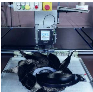
CNC-Nähanlage KL 102 zur textilen Montage der Rotorschaukeln auf den Rotorboden
