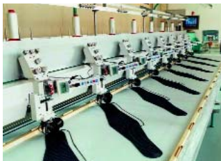
Nähtechnische Erprobung der Composite-Nähfäden auf TFP-Technik (Tailored-Fiber-Placement), Hightex Verstärkungsstrukturen GmbH, Dresden
