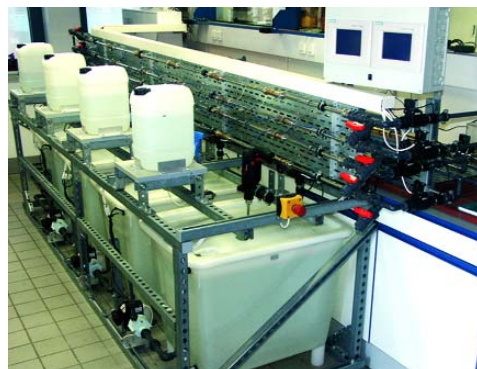
Abb. 2: Versuchsanlage zur Prüfung der Veränderung der Trinkwasserbeschaffenheit nach DIN 50931-1
