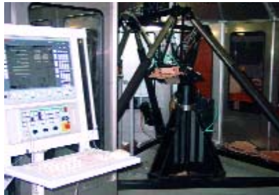
Hexapod „FELIX“ als Bearbeitungszentrum für Holzformteile (konfiguriert für bewegtes Werkstück)
