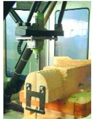
Konfiguration des parallelkinematischen Bearbeitungszentrums für bewegte Arbeitsspindel
