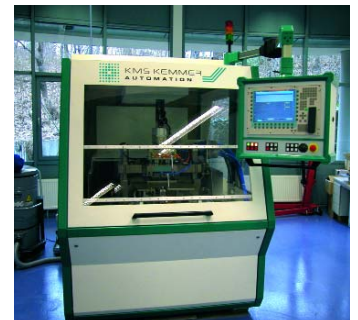
Stanzmaschine KMS 30 HE zur Bearbeitung keramischer Folien bei der KMS Kemmer Technology Center GmbH
