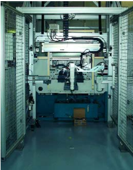
Automatisierung einer Profilwalzmaschine (Fotos: EKF AUTOMATION GmbH)
