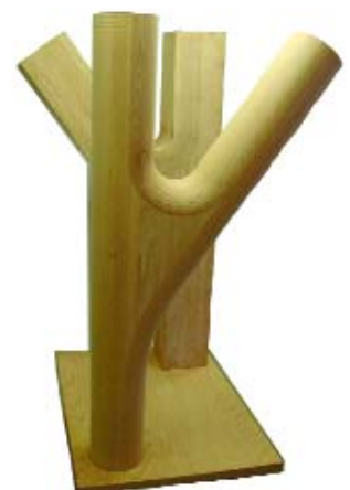
Mit „FELIX“ bearbeitetes Teil eines Holztragwerkes
